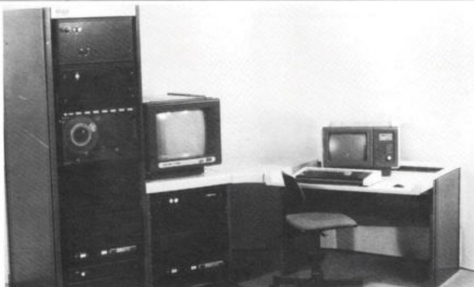
Afb. 4. Een van de oorspronkelijk aan de Sowjet-ruimtevaart geleverde beeldverwerkingsterminals Robotron A 6472. Rechts op de foto is de bedieningsenheid met rolkogel en toetsenbord zichtbaar. Links de real-time processor en de videomonitor. Momenteel is de eenheid wat uitgebreid met o.a. een schijfgeheugen.
